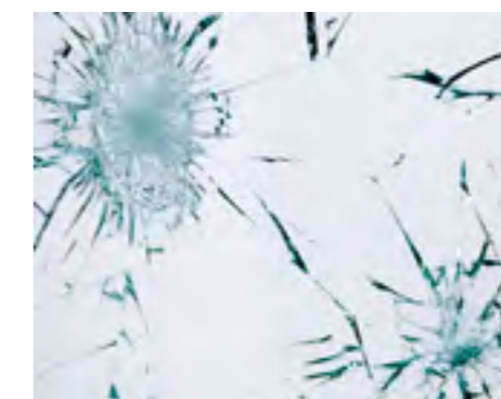
Ламинированное безопасное стекло невозможно пробить. Независимо от прилагаемой силы окно сохраняет свою целостность
