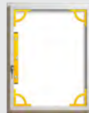
Готовая оконная створка растягивается по углам
