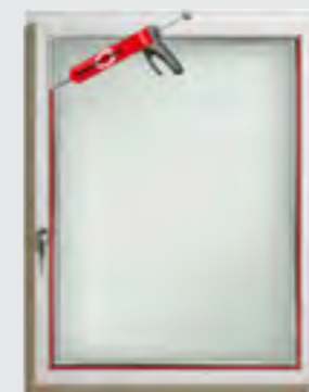
Оставшийся зазор между стеклом и рамой заполняется клеем по всему периметру
