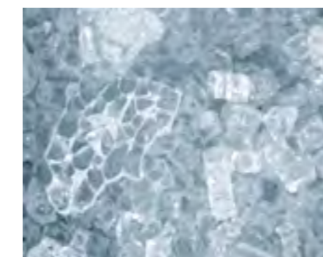
Безопасное оконное стекло разбивается на неострые осколки и защищает от получения травм
